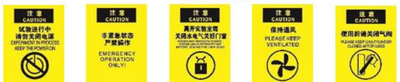
① 试验进行中请勿关闭电源 ② 非紧急状态 严禁操作 ③ 离开实验室请关闭水电气 ④ 保持通风 ⑤ 使用后请关闭气阀
